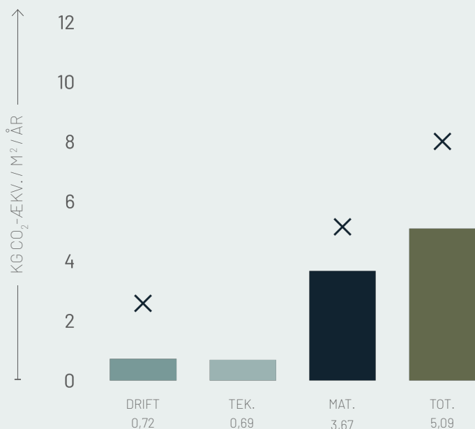
Figur E02.1: Udledningen af kg CO 2 -ækv. / m 2 / år Søjlerne viser bygningens klimapåvirkning. Krydsene indikerer det højeste resultat for drift, materialer og samlet udledning af kg CO 2 -ækv. / m 2 / år i casesamlingens etageboliger.
